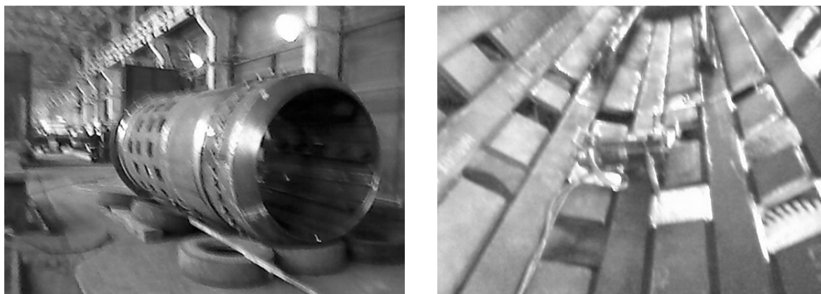
Рис. 6. Процесс вибрационной обработки: а – конструкция на опорах; б – закрепление вибровозбудителя
