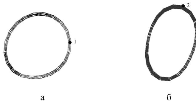
Рис. 3. Формы колебаний на первой (а) и второй (б) собственных частотах колебаний
